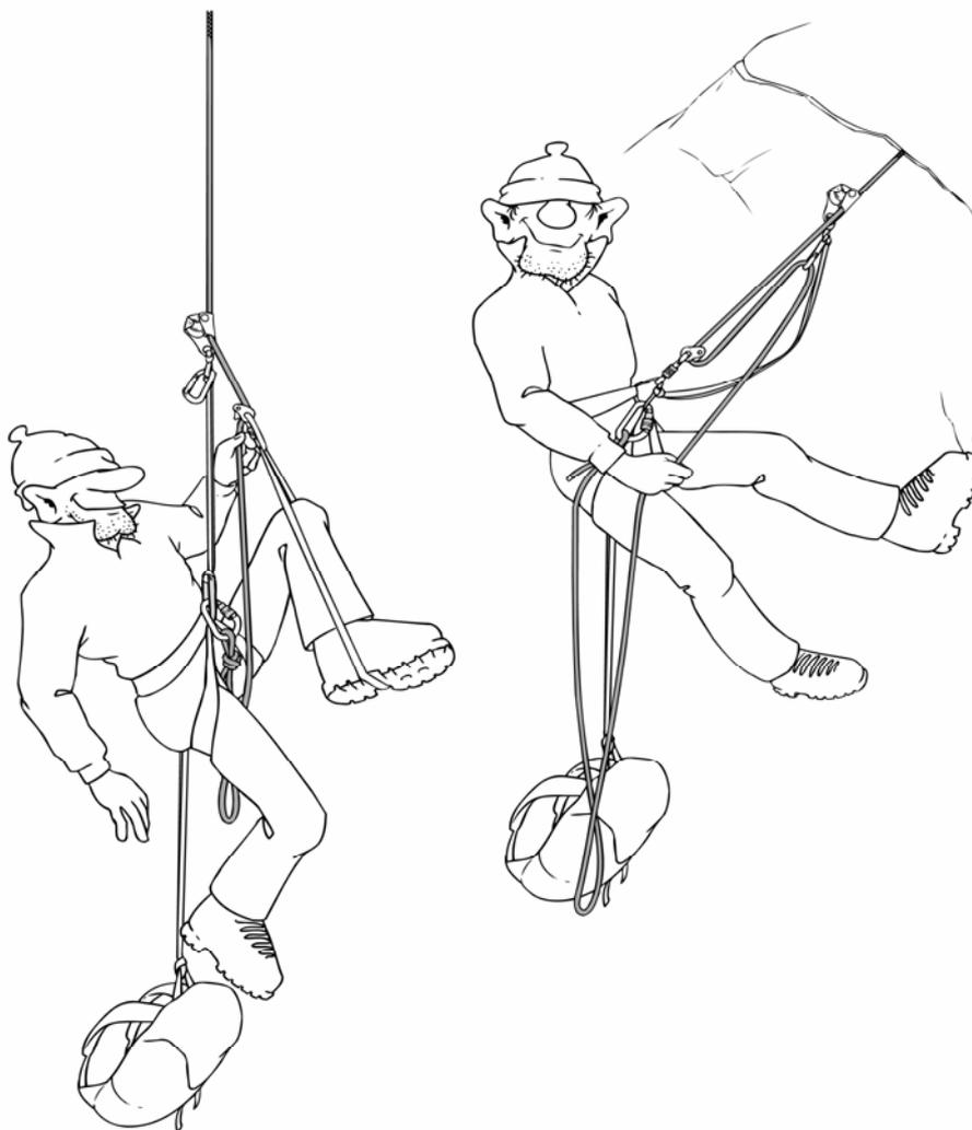
*Bild 10: Selbstflaschenzug mit alternativen Klemmen*
